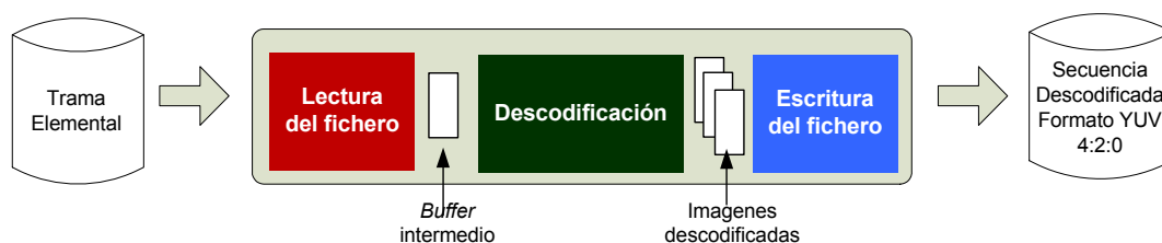
Figura 6-1 Banco de pruebas empleado para medir el rendimiento de los decodificadores aisladamente.
