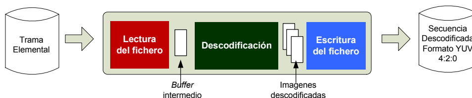
Figura 4-1 Banco de pruebas empleado para medir las prestaciones del descodificador aislado.
