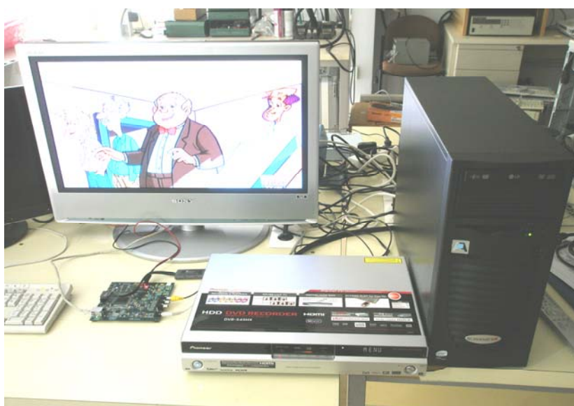
Figura 4-54. Banco de pruebas empleado para las medidas de rendimiento en un entorno real.
