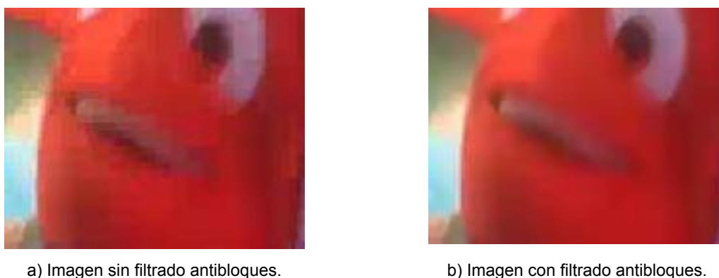
Figura 2-39. Comparativa de una misma imagen empleando o no el filtro antibloques.
