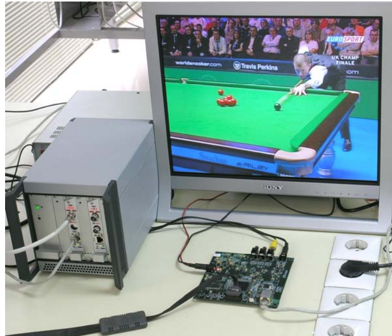
Figura 4-27 Banco de pruebas empleando un gateway comercial.
