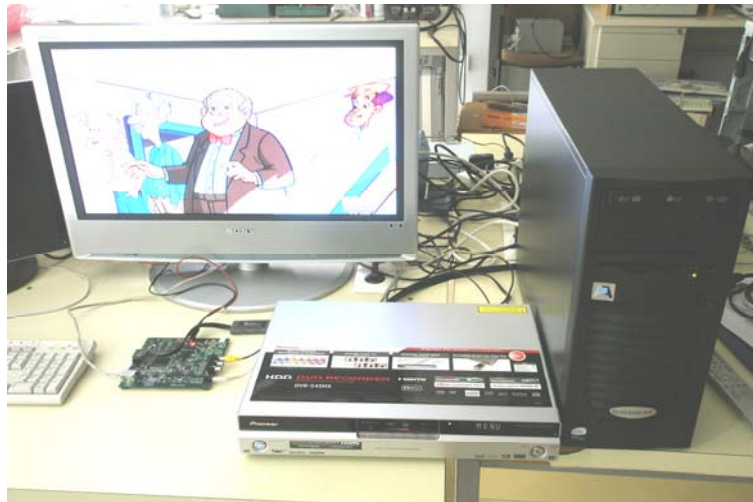
Figura 6-6 Imagen del banco de pruebas empleando un reproductor de DVD.
